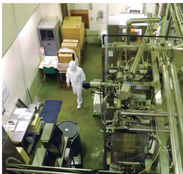
コンピューターの管理下で、1時間に牛乳(1リットル)6,500本、プリン9千個、ヨーグルト1万個が生産されている(写真はプリン製造ライン)
